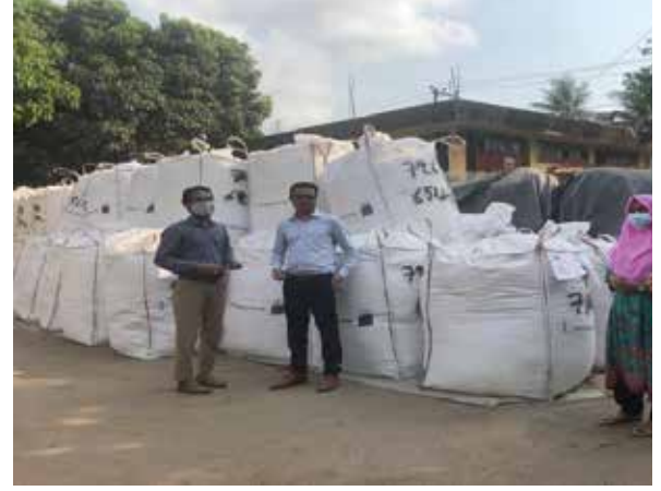
চিত্র: মেয়াদোত্তীর্ণ ৫০০ মে: ট: DDT পরিবেশসম্মতভাবে ডিসপোসালের লক্ষ্যে তিন স্তরের Multi-layer প্যাকেজিং।
