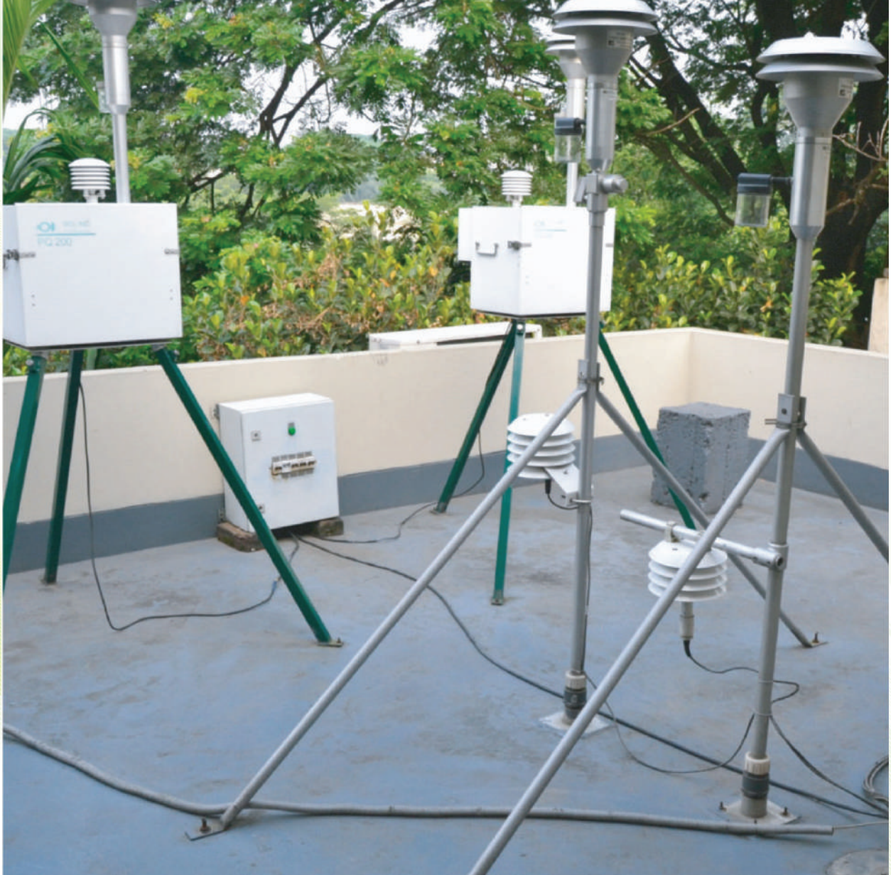
চিত্র ১৩: পরিবেশ অধিদপ্তর কর্তৃক ঢাকার দারুসসালামে স্থাপিত সার্বক্ষণিক বায়ুমান পরিবীক্ষণ কেন্দ্র (CAMS)
